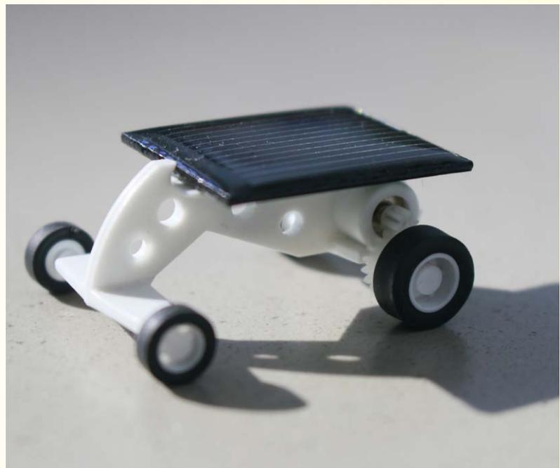
Kindergarten die Sonnenstrahlung durchlassen. Das Solarmodell funktioniert mit der Strahlung der Sonne. Die Energie der Strahlung wird in der Solarzelle in Strom umgewandelt. Je mehr Strahlen auf die Solarzelle treffen, desto schneller wird der kleine Motor angetrieben.
